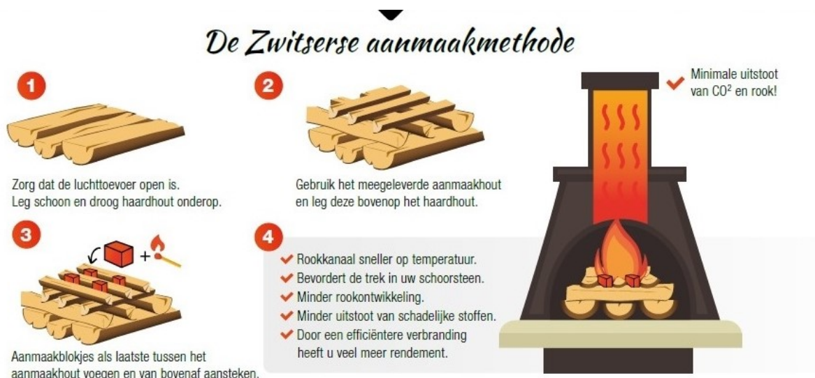
Afbeelding 4.3: Uitleg van de zogenoemde Zwitserse aanmaakmethode
