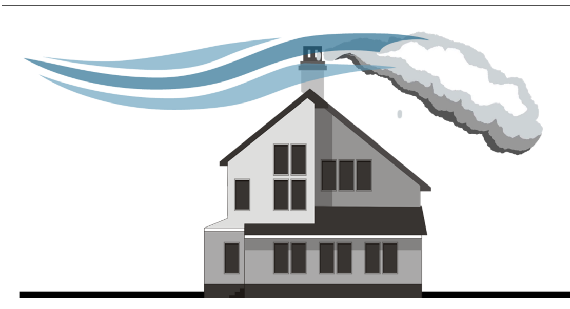
Afbeelding 8.13: Downwash effect bij rookgasafvoer boven nokhoogte
