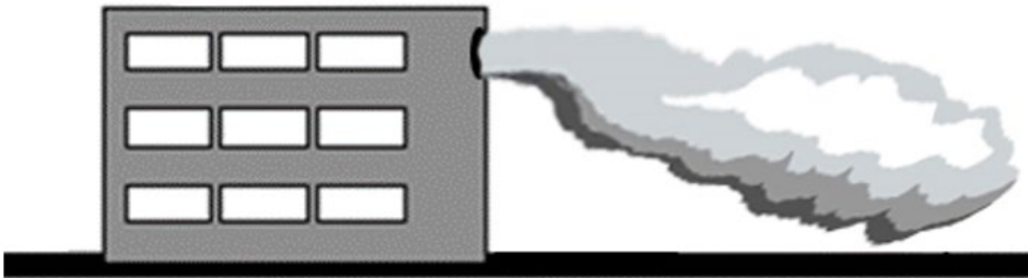
Afbeelding 8.3: Zeer slechte verspreiding bij een afvoerhoogte onder gebouwhoogte door invang van de pluim
