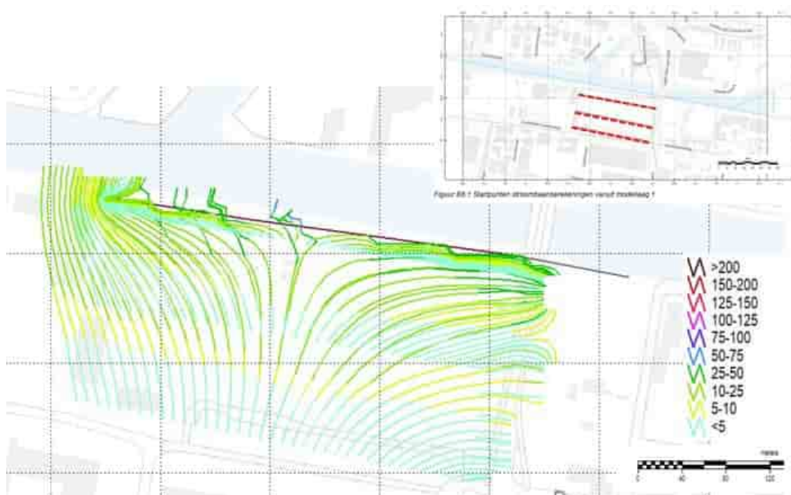
Figuur 2.26 Bovenaanzicht stroombanen referentiemodel vanuit freatisch pakket (start telkens met lichtblauw <5 jaar reistijd). Inzet startposities stroombanen, zie ook bijlage 6
