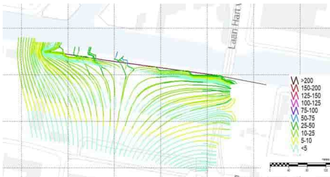
Figuur 3.25 Kopie figuur 2.25 bovenaanzicht stroombanen referentiemodel vanuit freatisch pakket, modellaag 1 (start telkens met lichtblauw < 5 jaar reistijd)
