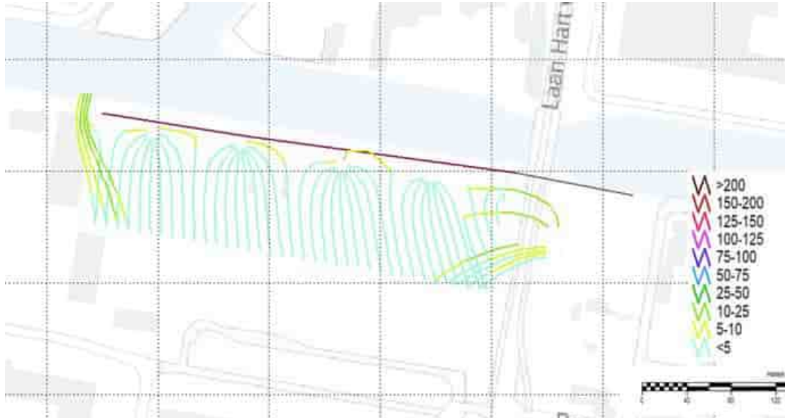
Figuur 3.6 Stroombanen scenario 3, startpunten in het watervoerend pakket, boven- en onderzijde van modellaag 3, reistijden in jaren en met kleur onderscheiden
