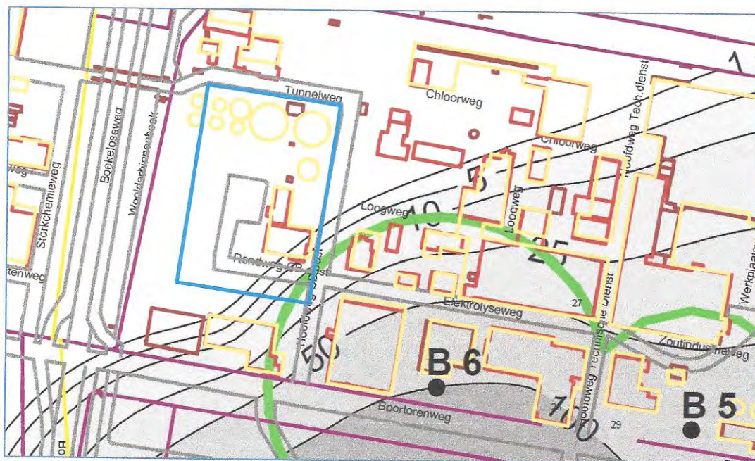
Figuur 1 Compilatie prognose 2050 bodemdaling voormalig CB Oost terrein (in mm, caveernecontour in groen, perceel Empyro in licht blauw)
