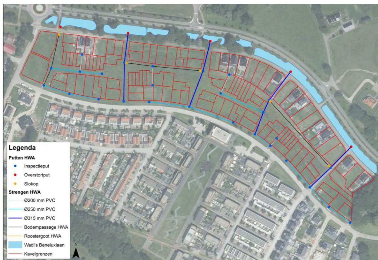
Figuur 9 Diameters hemelwaterstelsel
