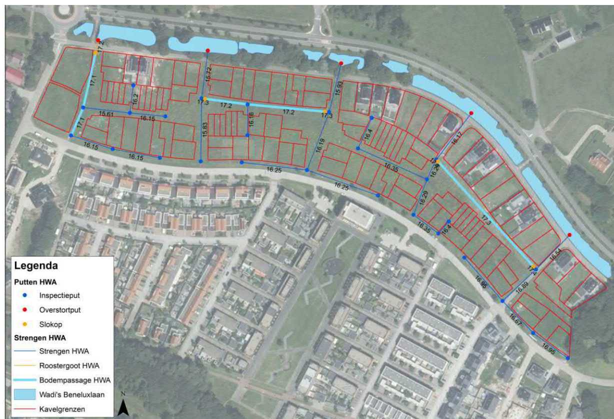
Figuur 10 Hoogteligging hemelwaterstelsel
