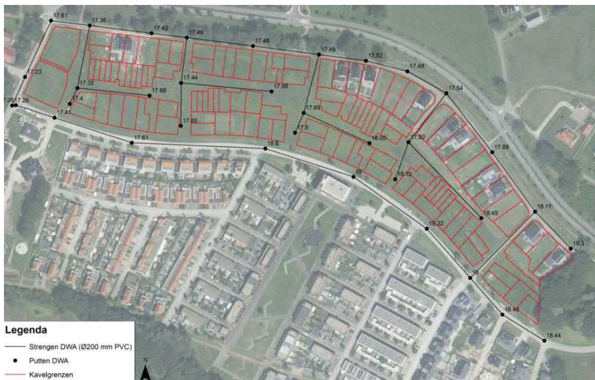
Figuur 5 Ligging DWA-riolen en minimale maaiveldhoogte
