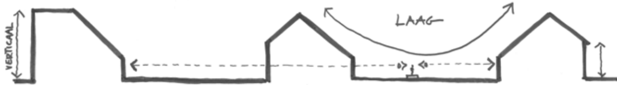
Principeddoorsnede van een kap over twee lagen.
