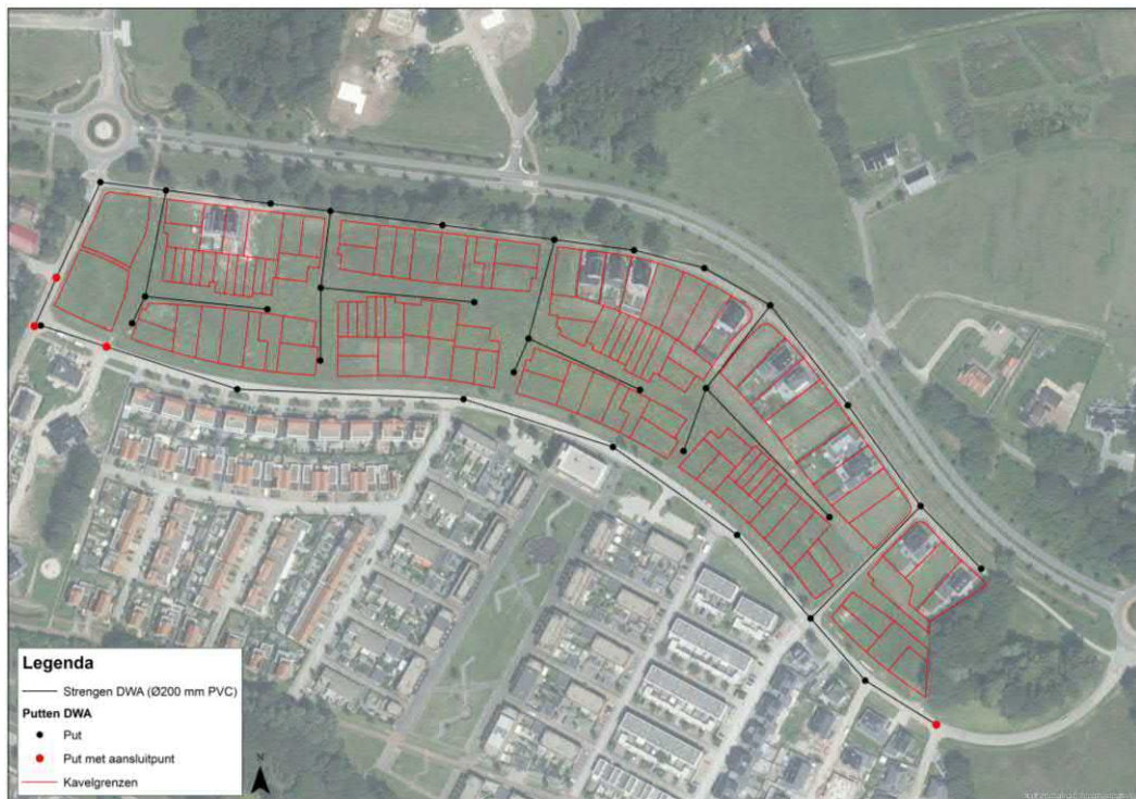
Figuur 4 Aansluitpunten DWA-stelsel
