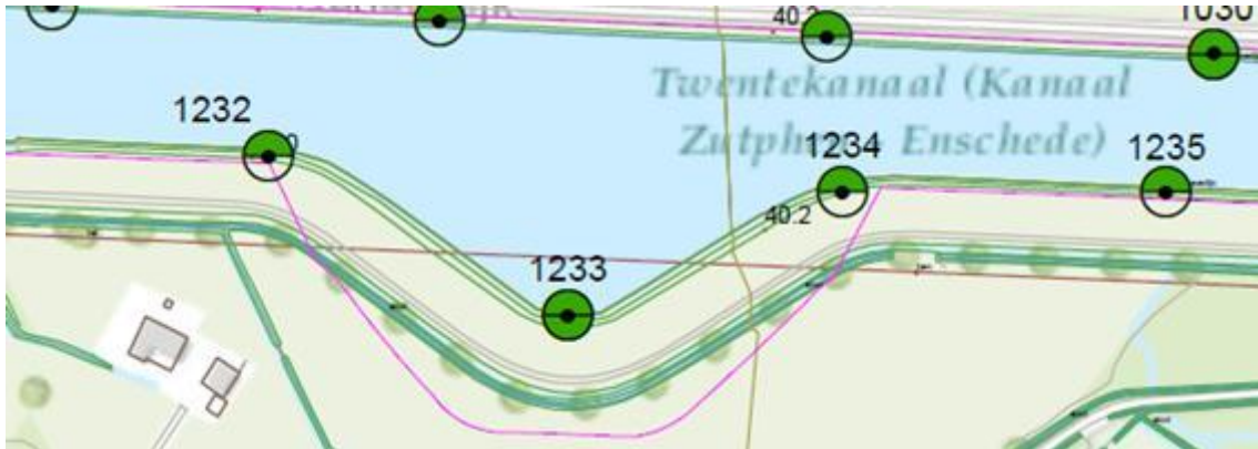
Afbeelding 14 Uitsnede en resultaten bodemonderzoek (groen betekent niet verontreinigd)
