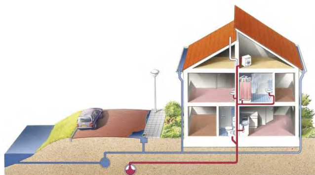
afbeelding 11: Gescheiden riolering. Bron: Paul Maas, Tilburg/Stichting RIONED
