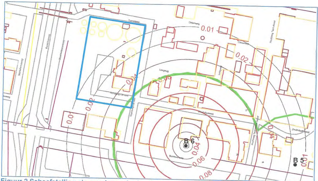
Figuur 2 Scheefstelling als gevolg van bodemdaling voormalig CB oost terrein (in mm/m, cavecontour in groen, perceel Empyro in licht blauw)
