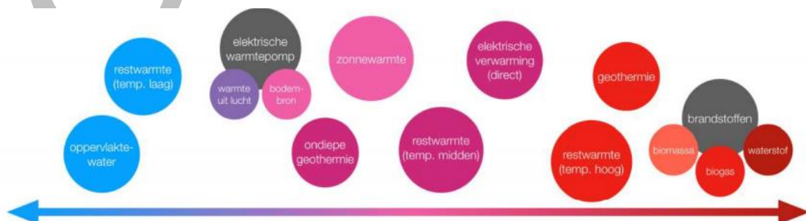
Figuur 3 Temperatuurniveau van verschillende warmtebronnen
