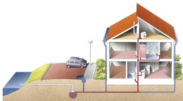
afbeelding 10: Gemengde riolering. Bron: Paul Maas, Tilburg/Stichting RIONED
