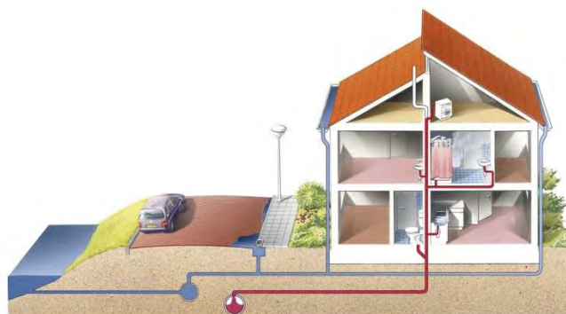
afbeelding 11: Gescheiden riolering. Bron: Paul Maas, Tilburg/Stichting RIONED
