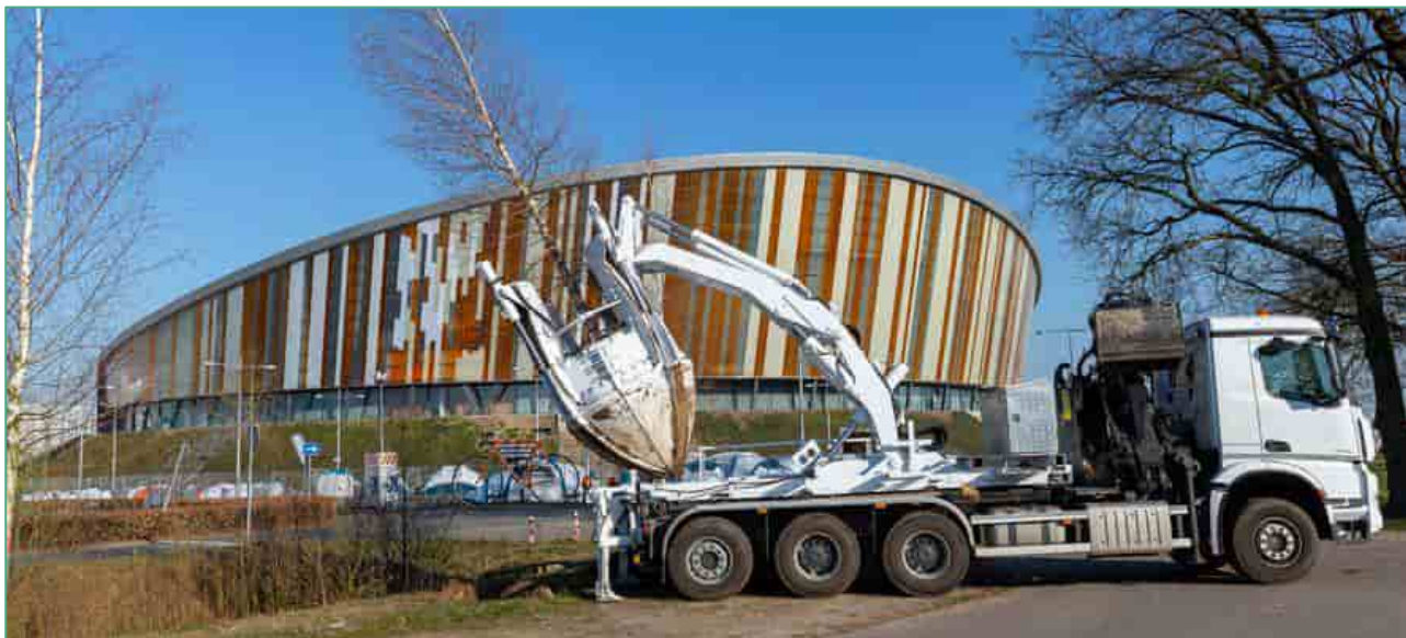
Afbeelding 4.30 Voorbeeld verplanting met behulp van de verplantmachine van idverde Bomendienst met een diameter van 1,9 meter.
