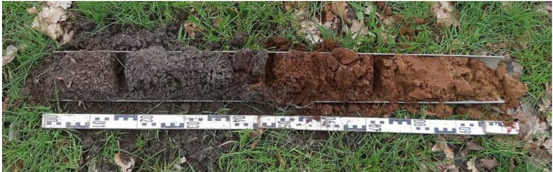
Afbeelding 5: Boring 1 met v.l.n.r. de grijsbruine subrecente ophoging, de bruine humeuze oorspronkelijke bouwvoor, de roodbruine veldpodzol en het gele dekzand.
