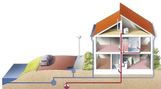
afbeelding 11: Gescheiden riolering. Bron: Paul Maas, Tilburg/Stichting RIONED
