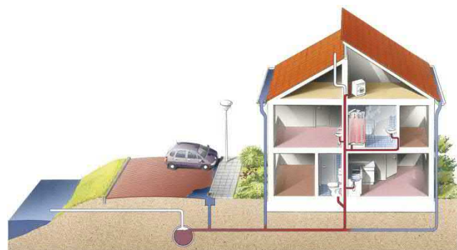
afbeelding 10: Gemengde riolering. Bron: Paul Maas, Tilburg/Stichting RIONED
